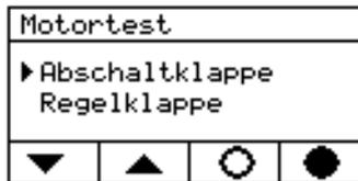
Mit den **Pfeiltasten** (Taste A und B) kann zwischen Abschalt- und Regelklappe gewechselt werden. Das leere Kreissymbol (Taste C) soll das Öffnen der Klappe darstellen. Der ausgefüllte Kreis (Taste D) symbolisiert das Schließen der Klappe. Erreichen die Klappen ihre Endposition, wird der Motorstrom automatisch abgeschaltet.
