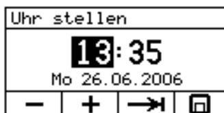
Mit der **Tab-Taste** werden die Stunden und Minuten ausgewählt und mit der **Plus-** u. **Minustaste** verändert. Ebenfalls das Datum eingeben.
