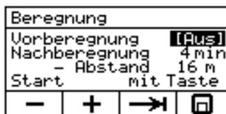
Mit der **Tab-Taste** (Taste C) wird der gewünschte Parameter ausgewählt. Der Wert des momentan ausgewählten Parameters wird auf schwarzem Hintergrund dargestellt. Mit der **Plus-** und **Minustaste** kann der Parameterwert verändert werden. Nach einer Eingabe müssen die Parameter gespeichert werden. Dazu ist die **Speichertaste** (Taste D) ca. 3s lang zu drücken, die eingestellten Parameter blinken während dieser Zeit und danach ertönt ein Signalton.
